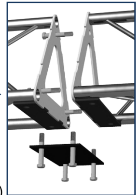
Схема крепления элемента 25-СК6
